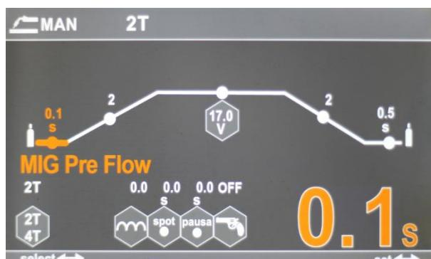
Obrazovka sekundárních parametrů
