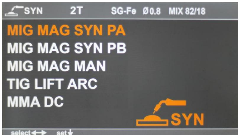
V tomto podmenu se opět k navigaci využívá levý enkodér V2. A vybrání metody provedete stiskem levého enkodéru V2.
