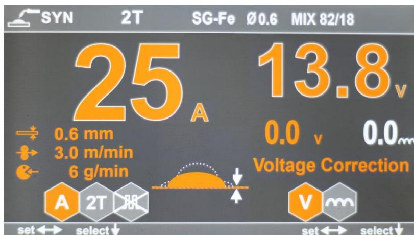
Na hlavní obrazovce v levém dolním rohu se stiskem levého enkodéru V2 a následným otočením doprava vybírají parametry dle potřeby uživatele. V pravém dolním rohu se stiskem pravého enkodéru V5 a následným otočením doprava nebo doleva mění korekce napětí nebo tlumivka.
