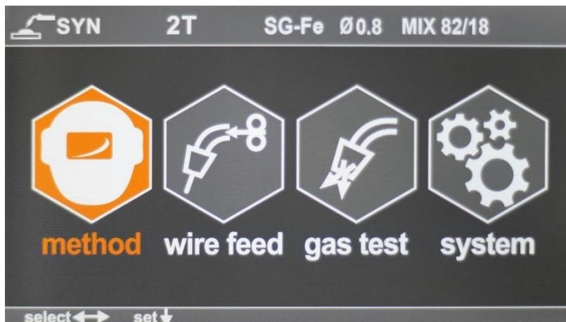
K pohybu po hlavním menu se využívá levý enkodér V2. Vybraná položka se oranžově zvýrazní a stisknutím levého enkodéru V2 vyberete položku. V případě zvolení „wire feed (nav. drátu)“ se po dobu držení stisknutého levého enkodéru zavádí drát. Při zvolení „gas test (test plynu)“ potvrzujete levým enkodérem V2, kdy dojde k otevření ventilu, druhý stisk ventil uzavře.
